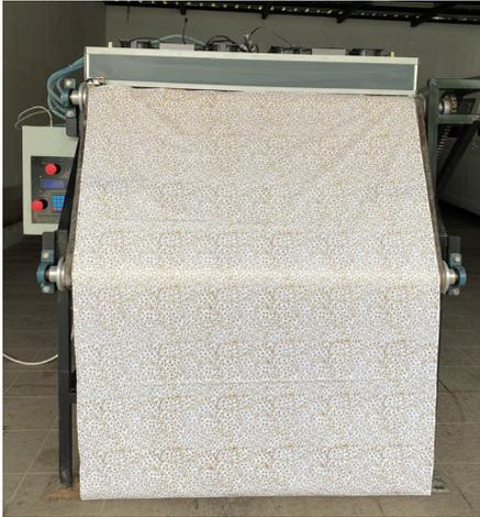
Gambar 4. Mesin fotonik batik yang terpasang batik
